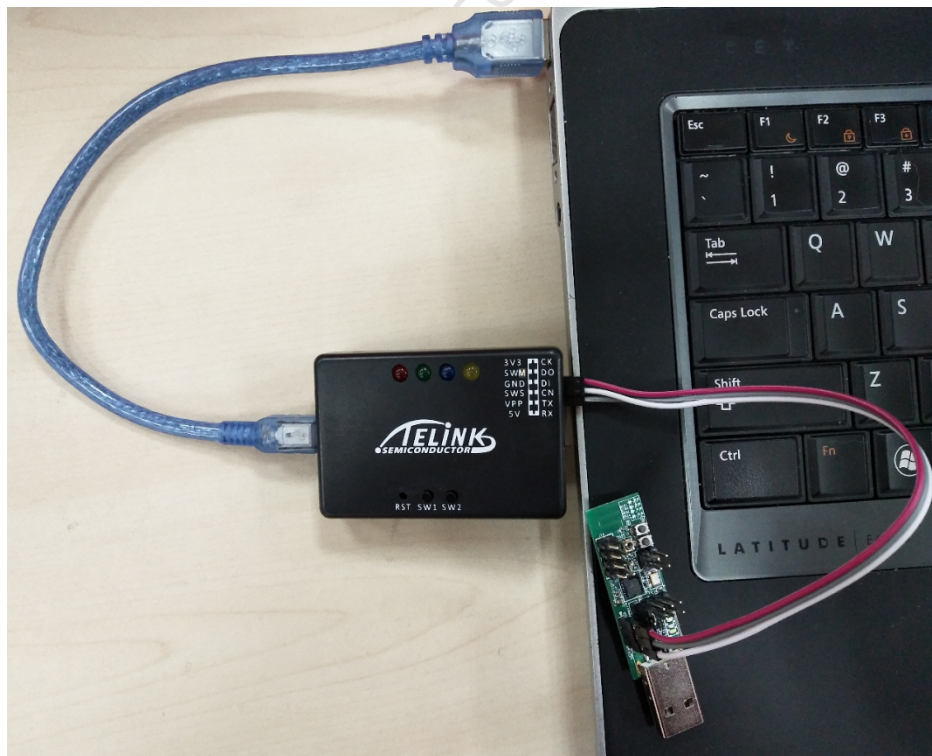
Figure 2.4: 通过 Swire 连接 “Burning EVK” 和目标板
