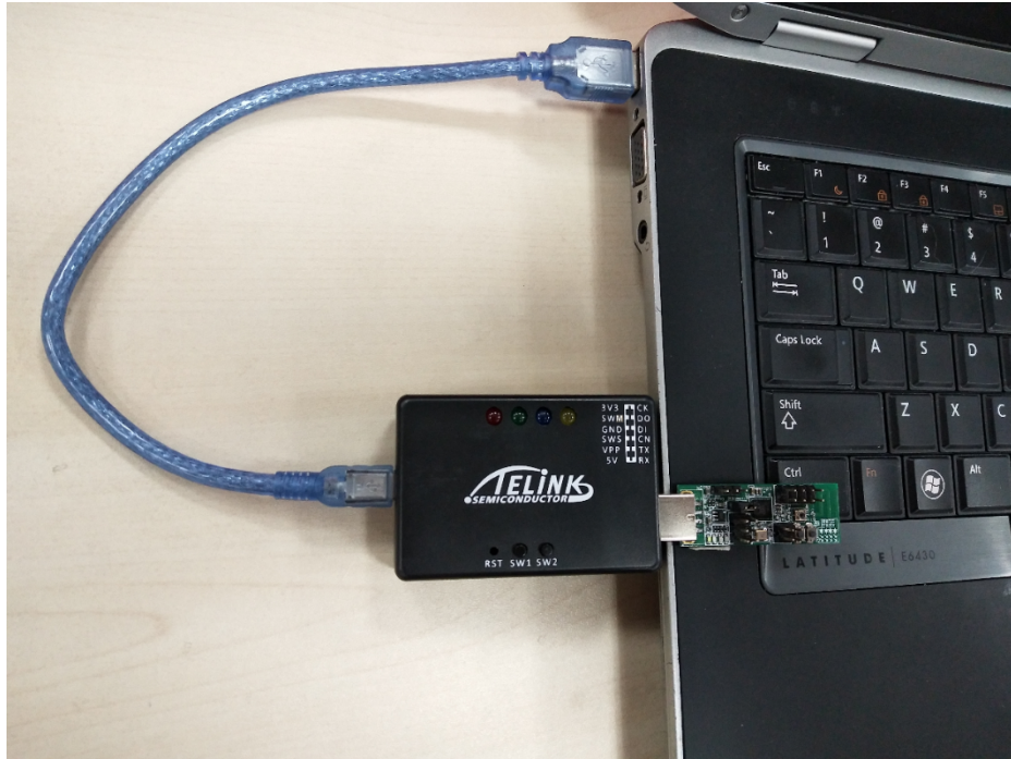
Figure 2.3: 通过 USB 连接 “Burning EVK” 和目标板
