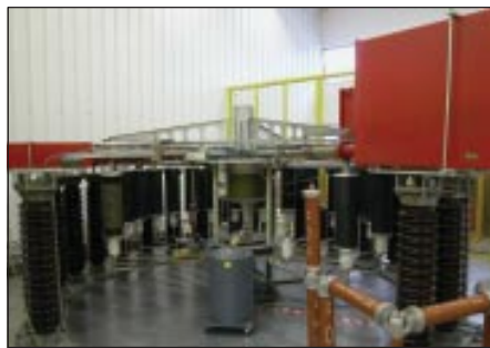
脉冲电流发生器可为防过载放电器测试提供 200kA 的电流。
