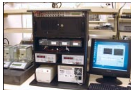
AXL 测试系统使用机械压力测试植入式医学器件。
