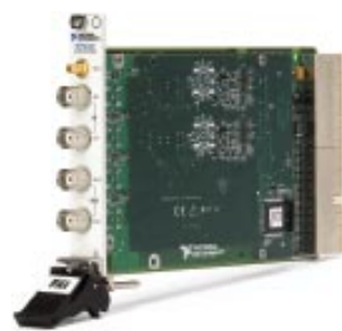
24 位的 delta-sigma A/D 转换器提供接近 120 dB 的动态范围。
