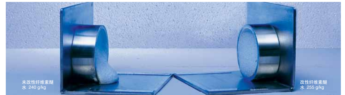
改性和未改性纤维素醚在标准瓷砖粘合剂配方中表现的稠度差别
