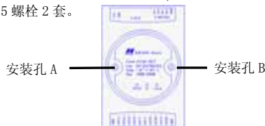
图 2-3 模块安装图示意图
