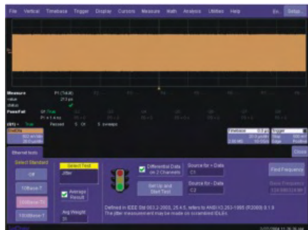
图 1.22 发送抖动测试结果
