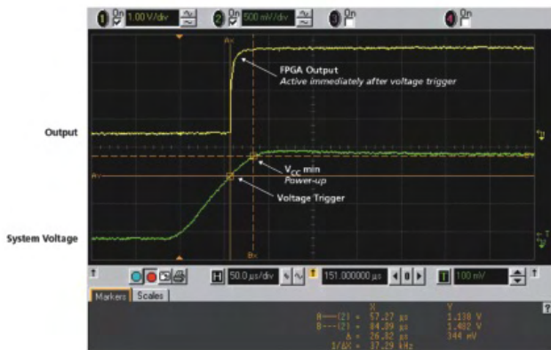
图 6 反熔丝FPGA的上电行为
