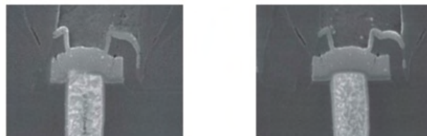
图 8 Actel 内部的晶体管编程后的横截面（左）和编程前的晶体管横截面（右）
