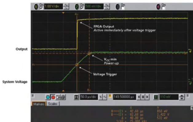
图 7 非易失ProASIC3/E Flash FPGA的上电行为
