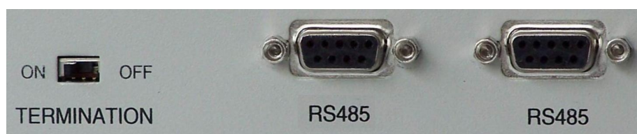
图 13、阻抗端接开关示意图
