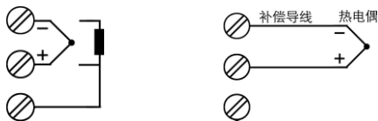
(1) 内部自动补偿模式 (补偿导线直接接到接线端子上)
