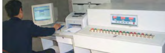
▲ 8000m 3 /h泵全性能测试台
