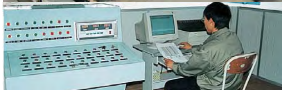
▲ 2000m 3 /h泵全性能测试台
