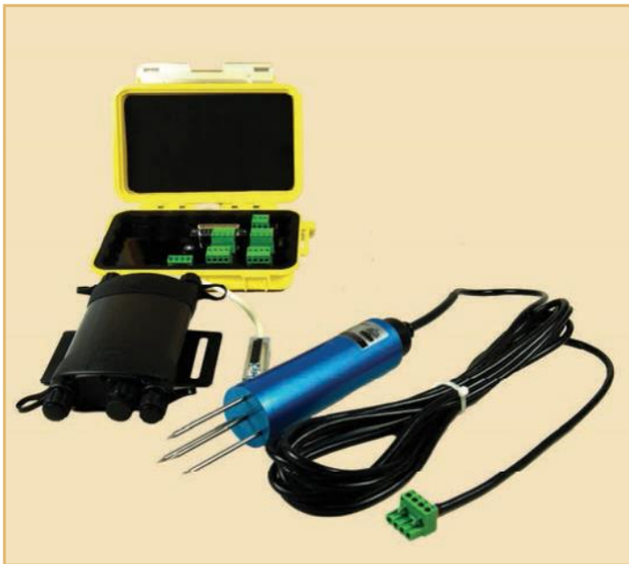
数据采集电路板, ICT 仪器 和 MP406 传感器
