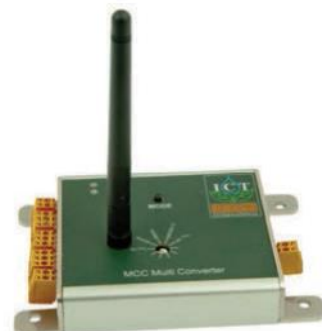
MCC 无线通信装置
