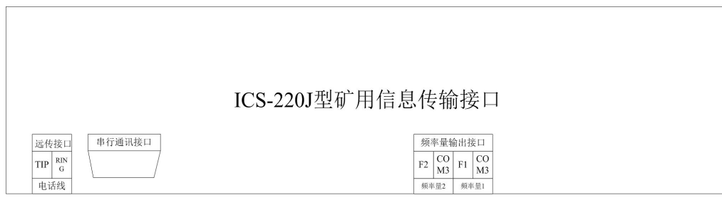
图 6 ICS-220J 矿用信息传输接口端子图
