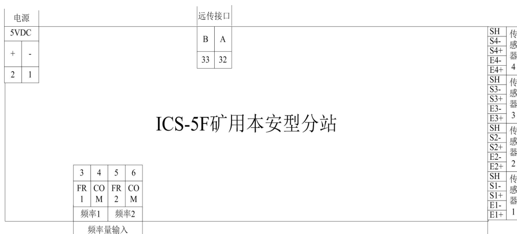
图 2 ICS-5F 矿用本安型分站接线端子示意图
