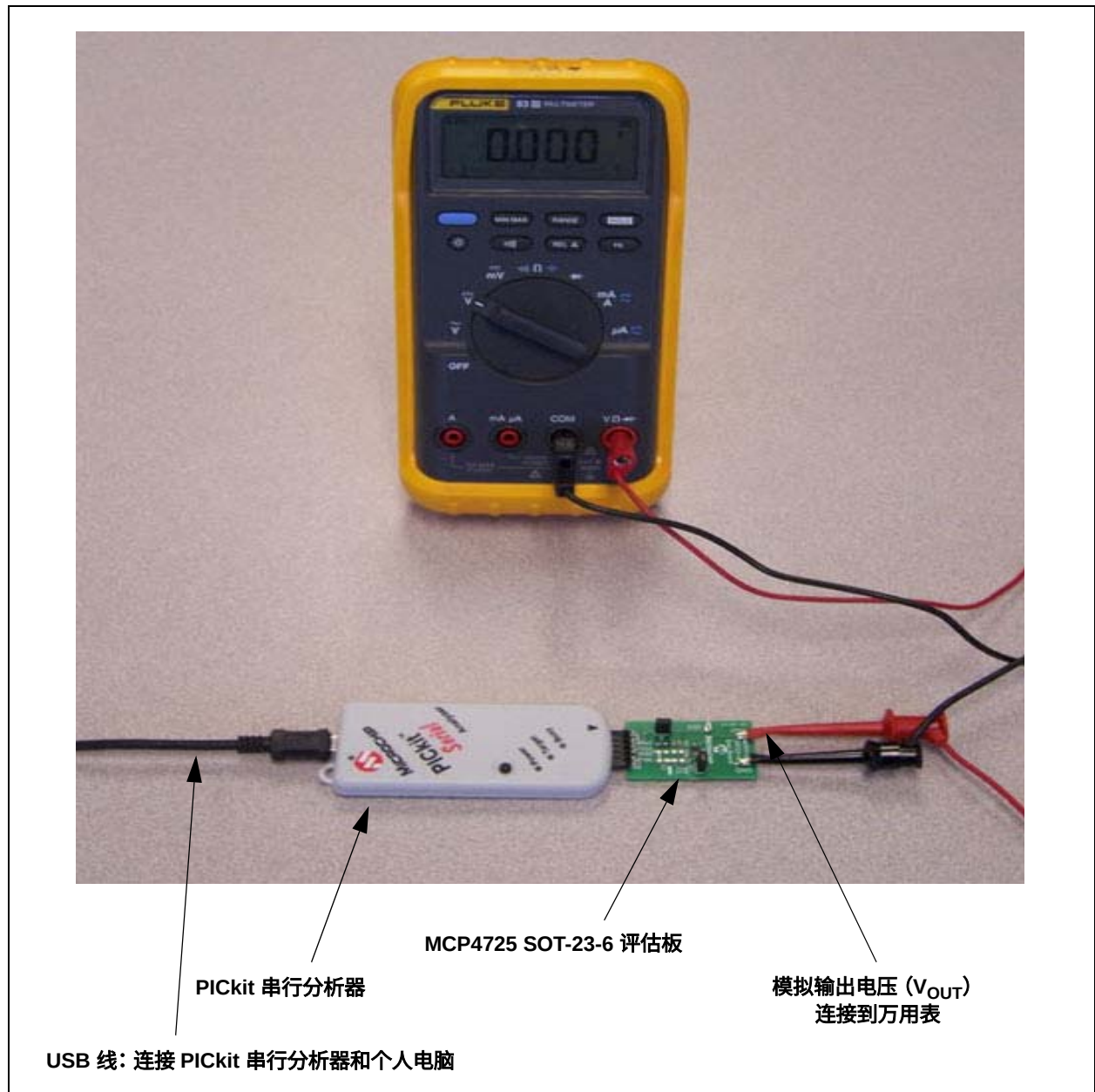
图 1-2 : MCP4725 SOT-23-6 评估板测试设置
