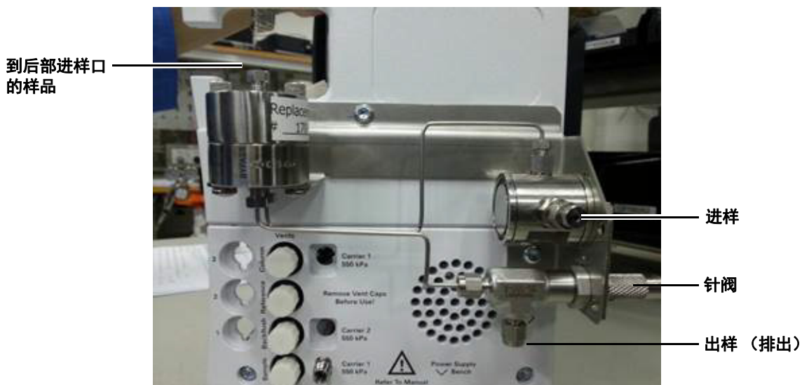
图 22 已安装 G3581-S0003 压力调节器配件
