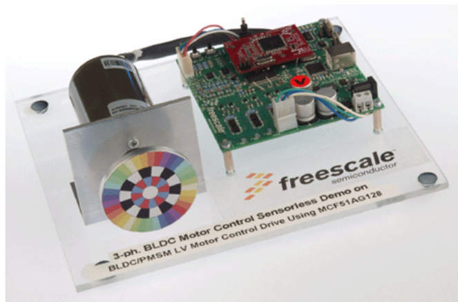
图2 采用MCF51AG128无传感器三相BLDC马达演示板外形图
