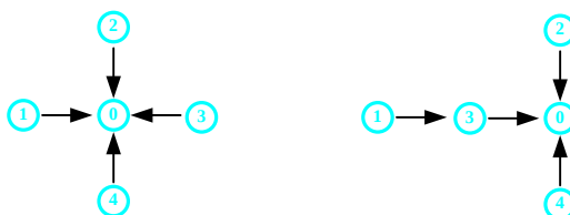
图 6 地线布局示意图
