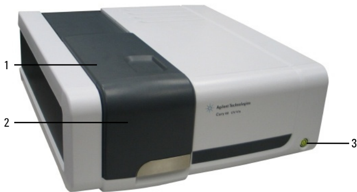
图 5. 显示样品仓盖 (1)、样品仓前门 (2) 和电源按钮 (3) 的 Cary 60
