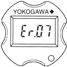
图 8.5.1 用内藏指示计检查故障
