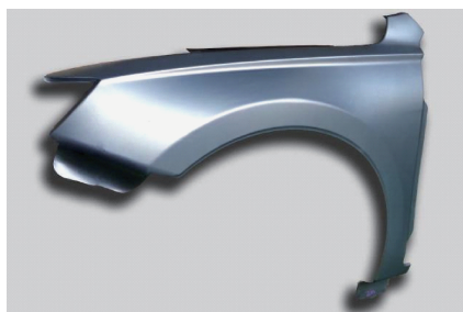
图 10 宝钢锌铝镁镀层钢板加工的汽车零件
