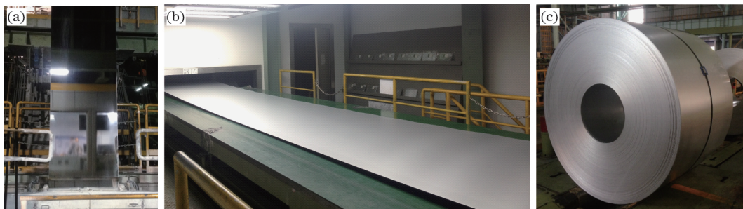
(a) 出锌锅后; (b) 在表面质量检查台; (c) 卷取后。
