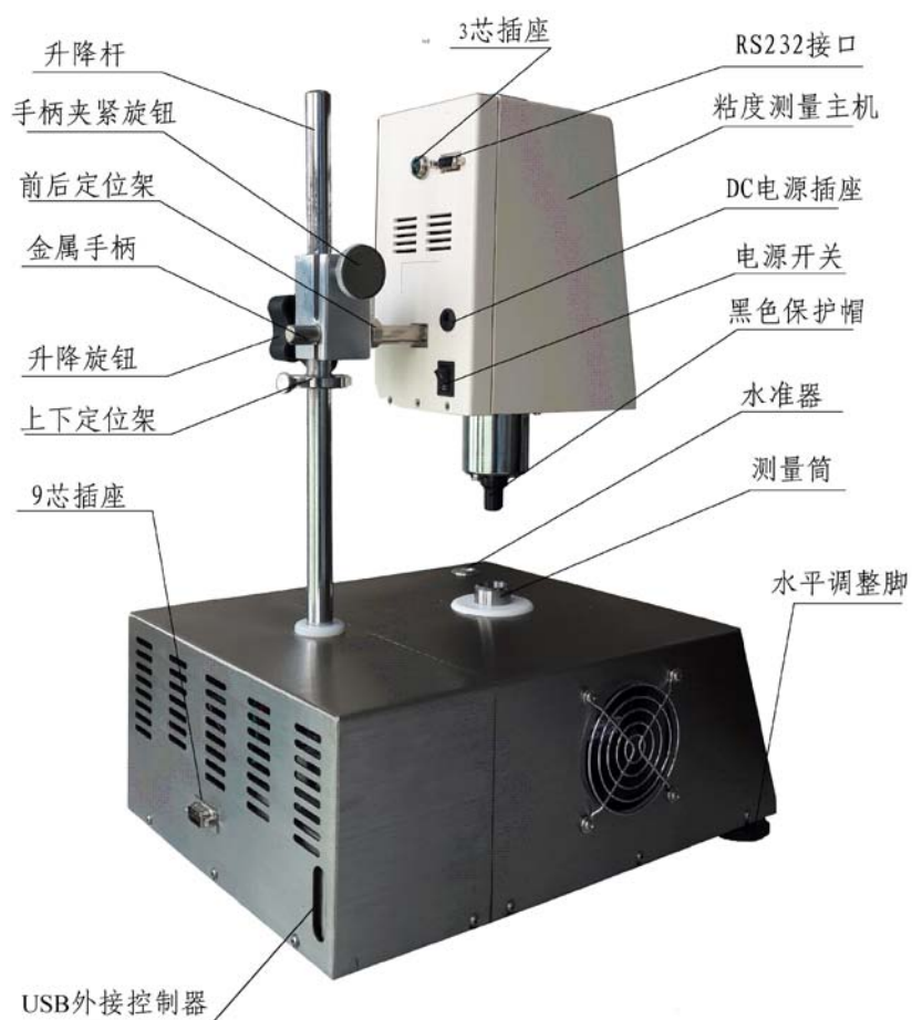
粘度测量仪安装示意图
