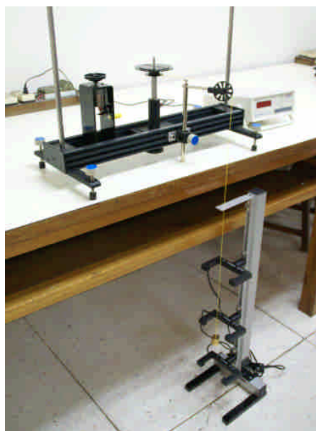
圖 10 轉動慣量測量裝置圖
