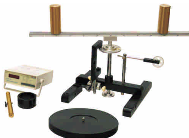
(b) 圓柱體之轉動慣量測量之裝置圖
