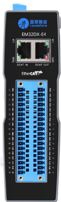
图 6.1. EM32DX-E4 模块外形
