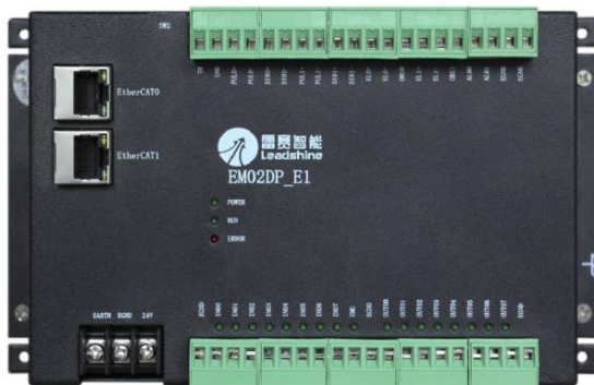
图 6.3. EM02DP-E1 定位模块外观
