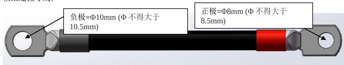
图 15模组连接导线示例
