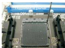
ШАГ 1. Поднимите рычаг гнезда.
