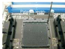
PASO 1: Levante la Palanca del Zócalo
