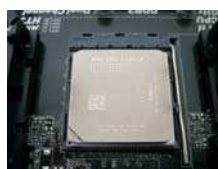
FASE 4: Abbassare e bloccare la levetta socket
