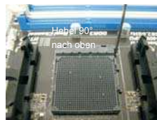
SCHRITT 1: Ziehen Sie den Sockelhebel hoch
