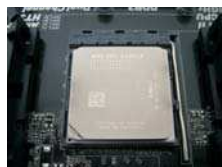
ШАГ 4. Прижмите и зафиксируйте рычаг гнезда.
