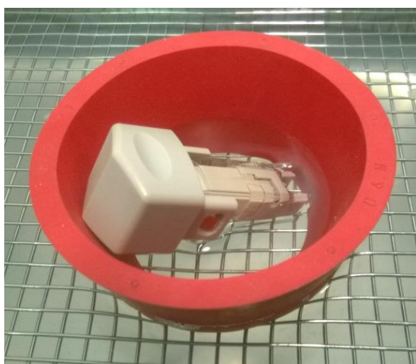
图. 59:铂电极非常坚固，可以用瓶刷等物理清洁法
