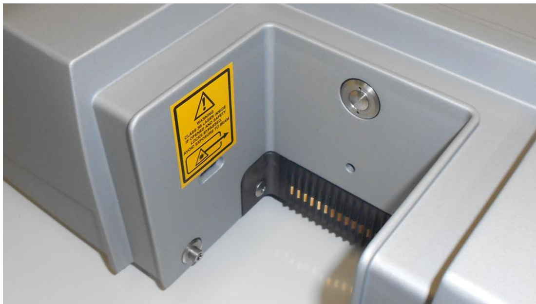
图 1： 激光标识位置以及模块插入腔
