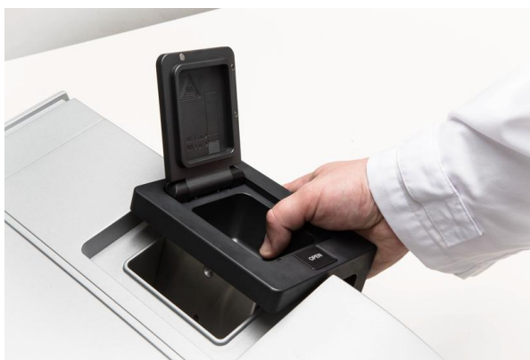
图 1-1： 拆卸样品池模块
