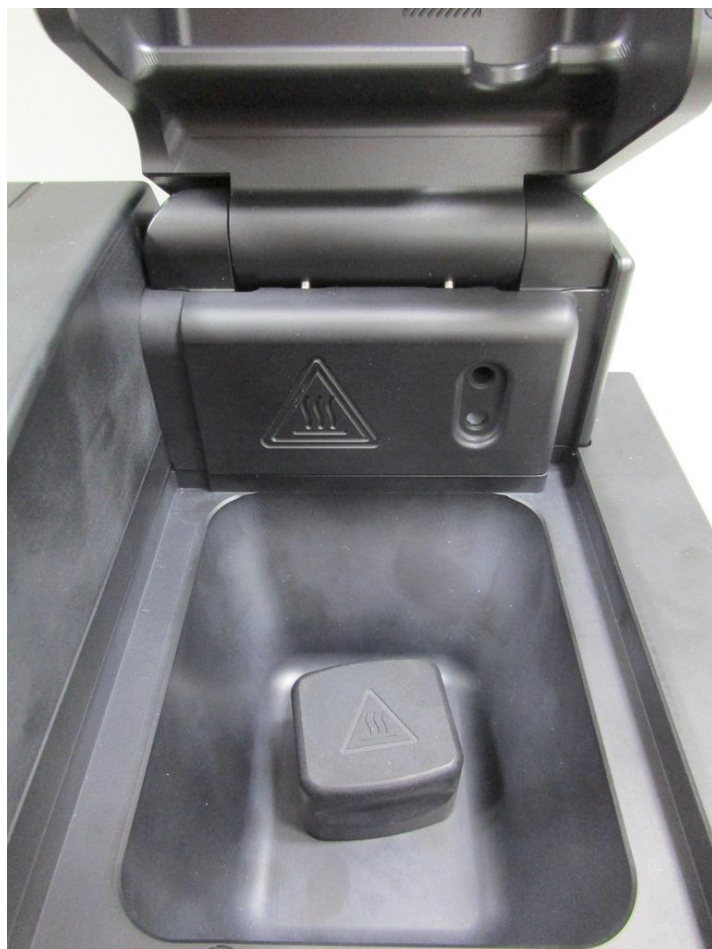
图 4： FM10 模块内侧的热表面安全标识以及保温盖热表面标识
