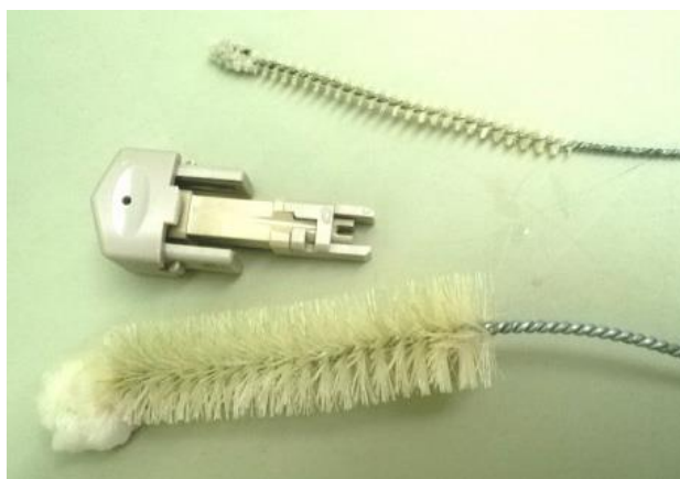
图. 58:铂电极非常坚固，可以用瓶刷等物理清洁法
