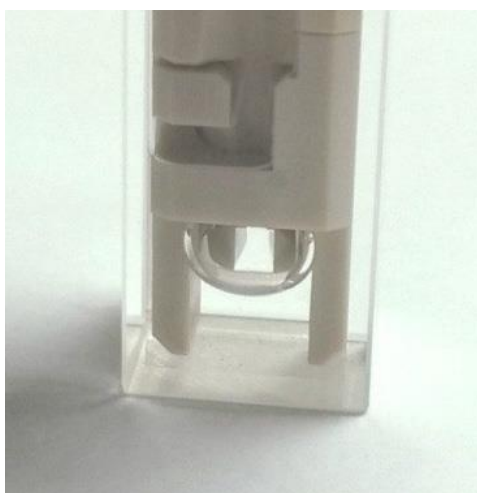
图 31: 电极片之间的气泡
