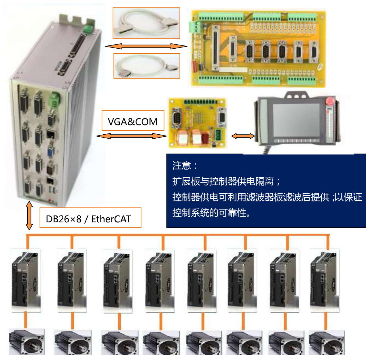
图 2.1-2 Alone ( AMC+VGA ) 模式基本配置示意图
