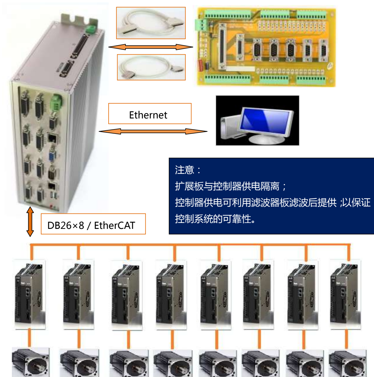
图表 2.1-4 A+PC 模式基本配置示意图
