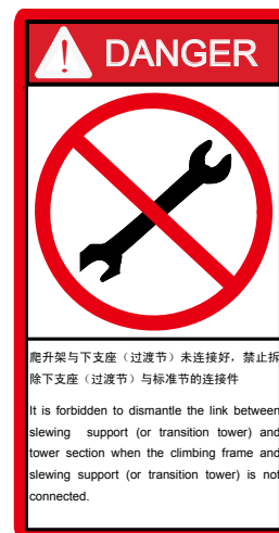
爬升架与下支座（过渡节）未连接好，禁止拆除下支座（过渡节）与标准节的连接件
