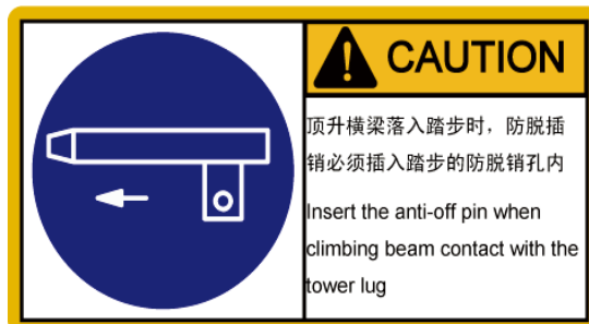
顶升横梁落入踏步时, 防脱插销必须出插入踏步的防脱销孔内
