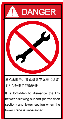
塔机未配平，禁止拆除下支座（过渡节）与标准节的连接件
