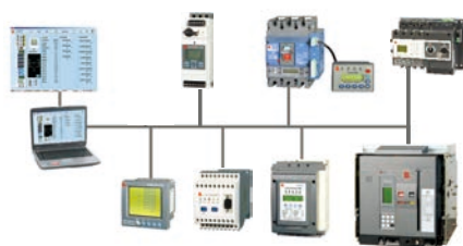
Riyea-PowerNet配电监控系统
