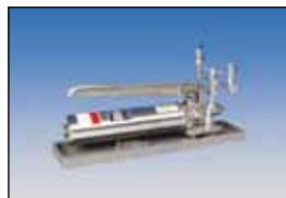
型号：T 介质：油或水 量程：0 ~ 100MPa 备注：轻松造压，省力，快捷方便
