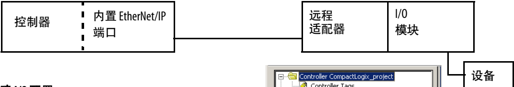
图 13 - EtherNet/IP 分布式 I/O 配置
