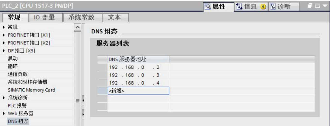
图 6-1 输入 DNS 服务器地址（以 CPU 1516-3 PN/DP 为例）
