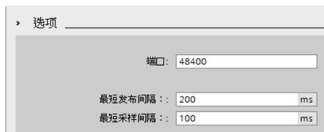
图 9-28 STEP 7 中的“最短发布时间间隔”(Minimum publishing interval) 和“最短采样时间间隔”(Minimum sampling interval) 设置
