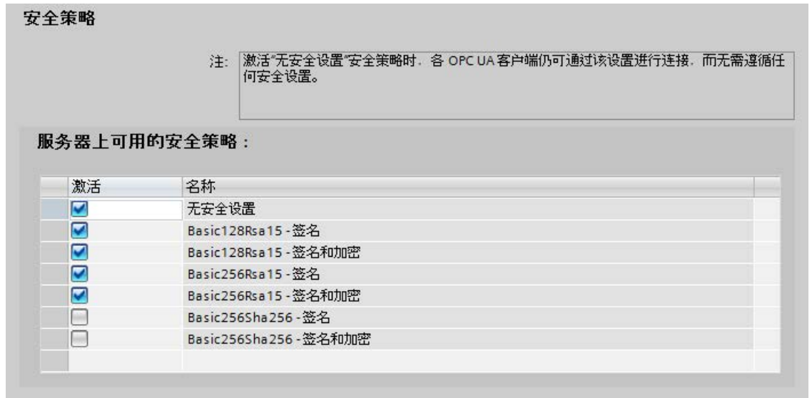
图 9-32 STEP 7 中 OPC UA 服务器的安全设置
