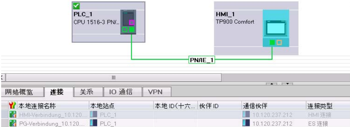
图 12-1 连接表的在线视图
