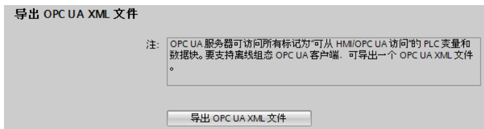
图 9-22 在 STEP 7 中导出 OPC UA 文件
