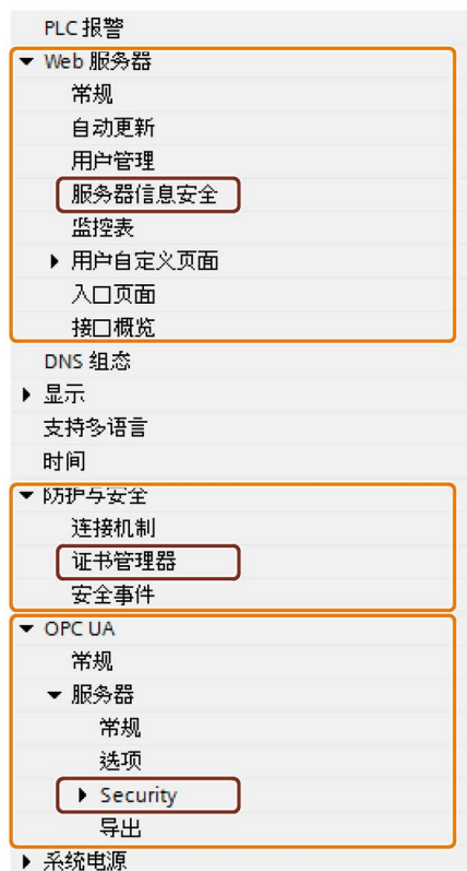
图 6-17 STEP 7 中 S7-1500 CPU 的安全设置
