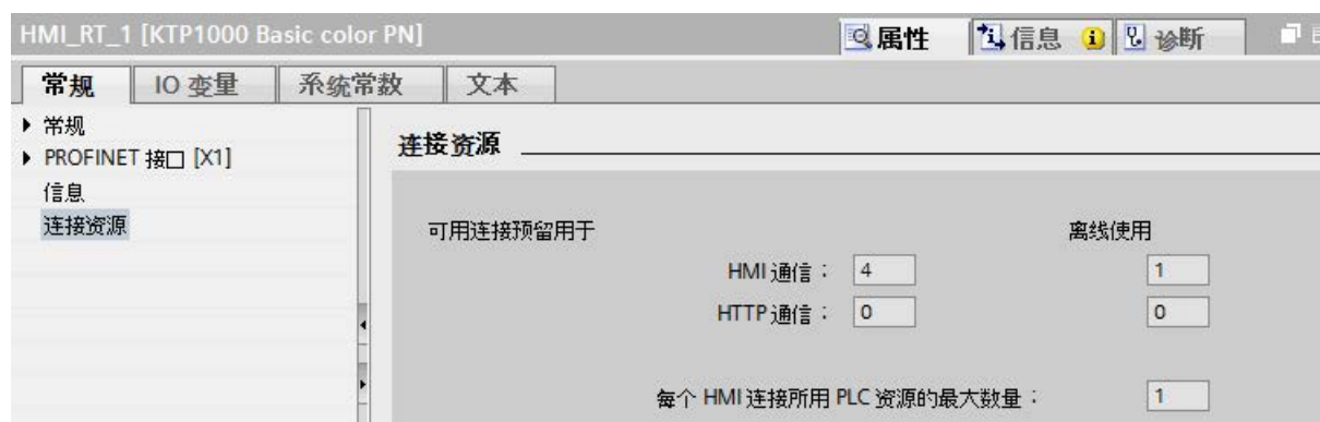
图 11-6 连接资源 - HMI 通信
