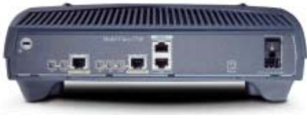
图 4 Cisco 1710 安全接入路由器后视图
