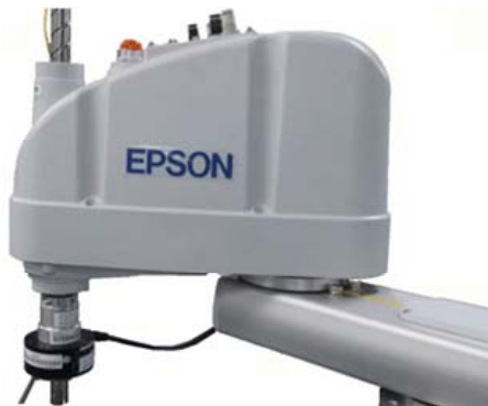
配备伽马力传感器的 SCARA 机器人
