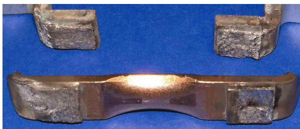
AC-3 应用中动、静触头寿命的初始阶段
