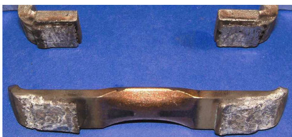
AC-3 应用中动、静触头的寿命中期阶段
