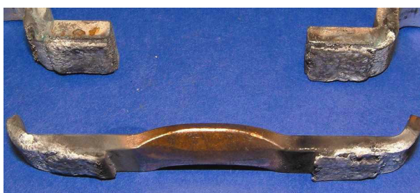
AC-3 应用中动、静触头的寿命终期阶段
