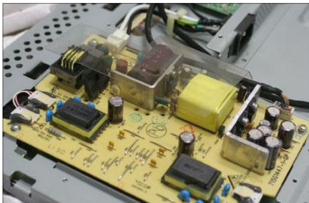
品牌机二合一高压电源板
