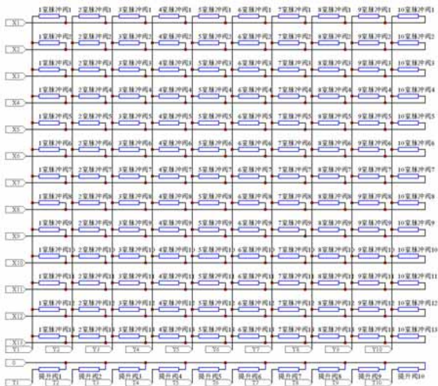
图 5 电磁阀接线图
