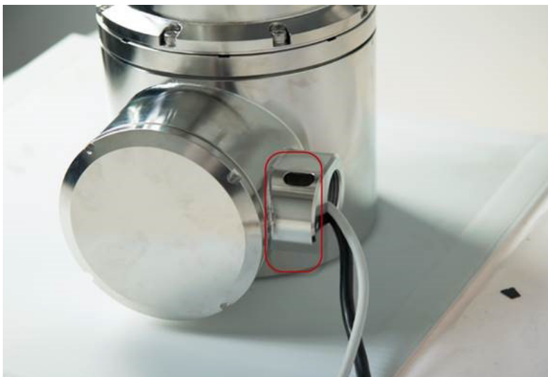
图 1. 将安全带或电缆连接到上面所示的孔中
