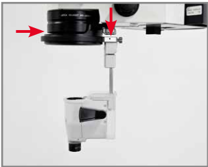
工作距离 WD200: 物镜的 WD 标记必须与悬挂装置上的激光刻记一致。
