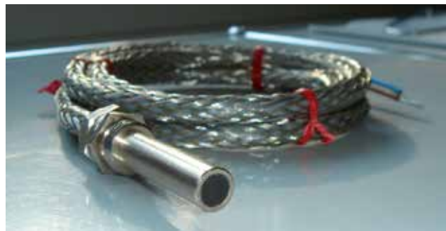
El sensor inductivo producido en 1973 para uso interno (versión especial para condiciones extremas)
