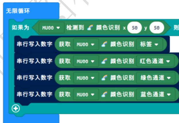
识别图像中心区域颜色并通过串口输出
