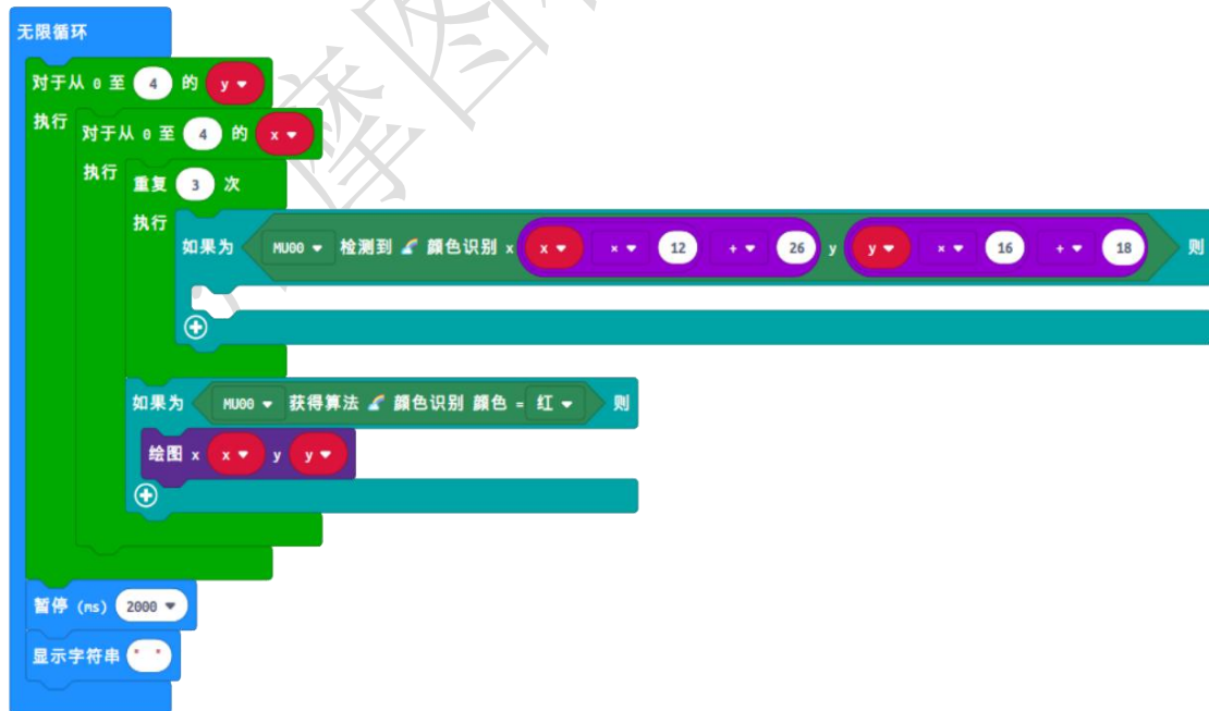
在 5x5 矩阵内检测红色色块，并在 LED 屏幕对应位置上显示
