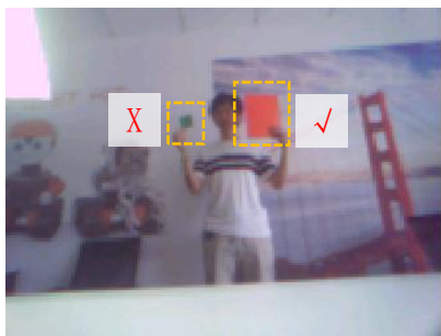
远距离，左侧的小卡片无法被检测到，而右侧的大卡片可以
