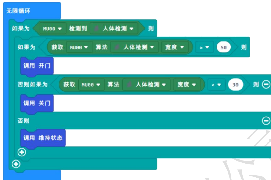
利用施密特触发控制门的开启与关闭
