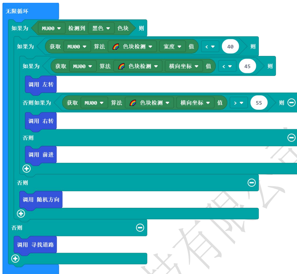
利用色块检测实现单线循线
