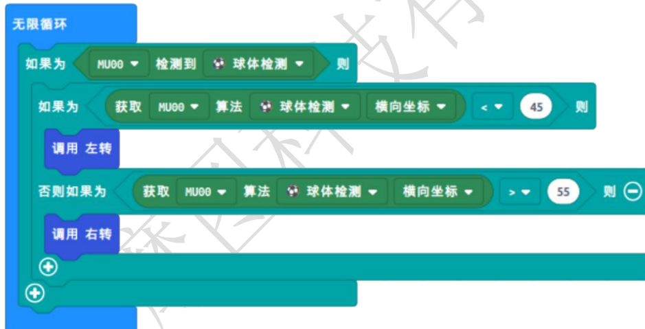
通过判断 X 水平坐标来控制左右转弯
