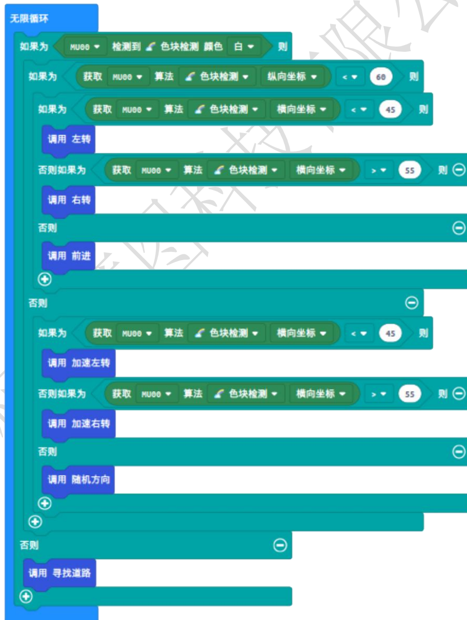
利用色块检测实现模拟道路循线
