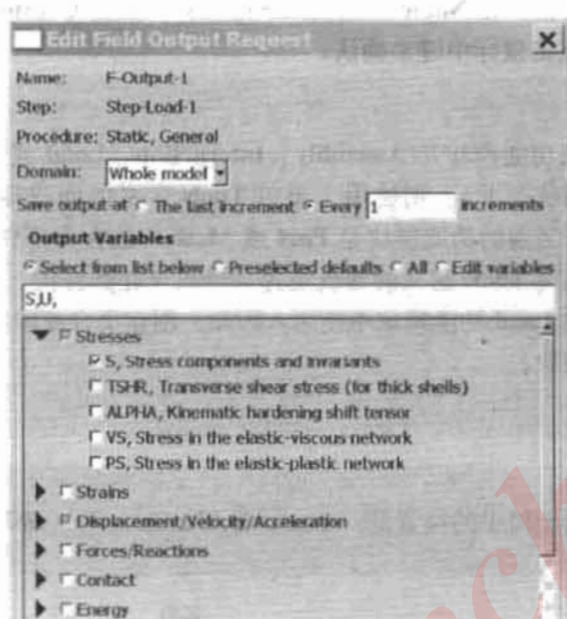
图 3-21 设定场变量输出结果
