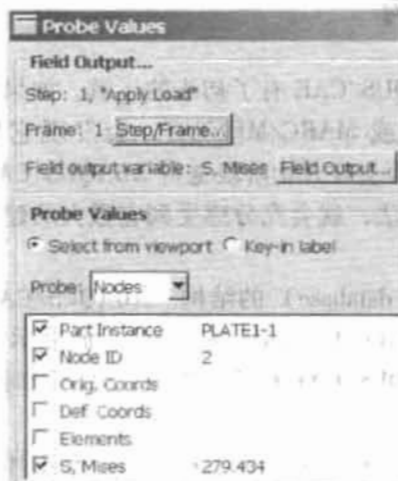
图 2-26 显示节点 2 的 Mises 应力
