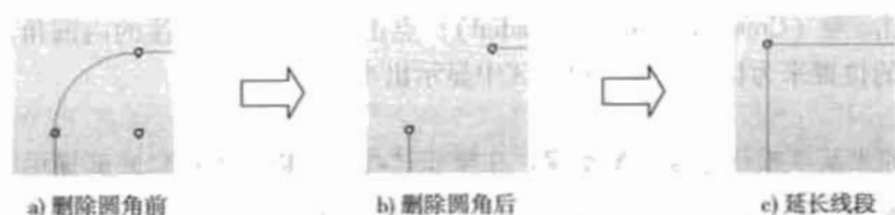
图 3-4 去除部件左上角的小圆角，然后延长此处的水平和竖直线段，使二者相交
