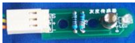
图6-4 灰度传感器实物图
