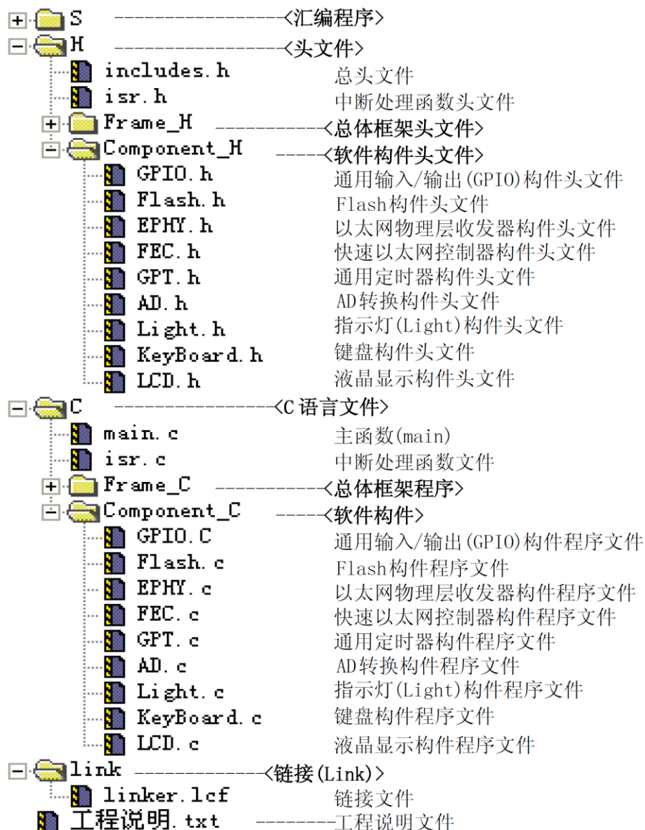
图16-16 高温炉温度控制系统工程相关源文件的树型结构
