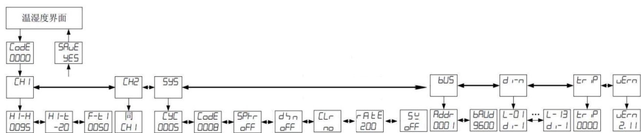
图 2.5 ASD200 菜单结构 Figure 2.5 ASD200 menu structure
