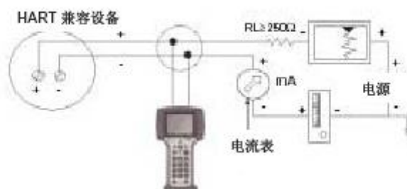
图3-2. 与HART回路的连接
