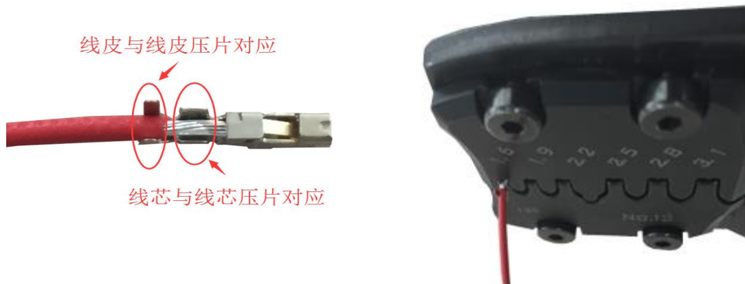
图 10.4- 11 将线插入端子（1827570-2）示意图
