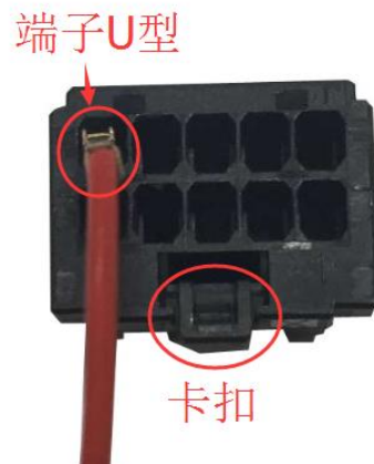
图 10.4- 16 端子（1827570-2）与端子连接器对应示意图
