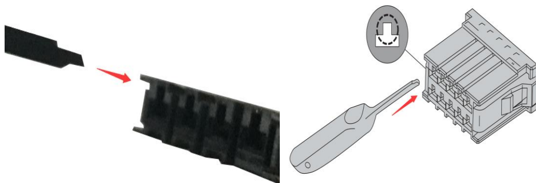
图 10.4- 21 退针工具插入线端连接器的方式
