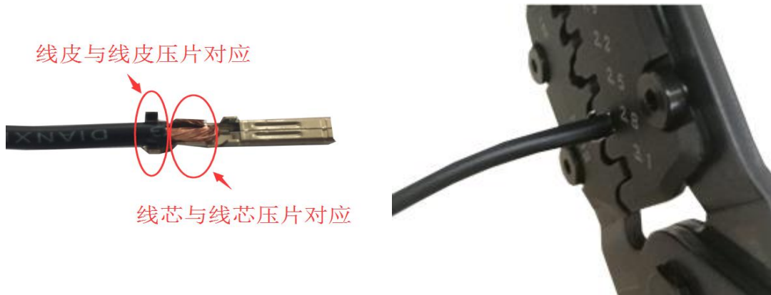
图 10.4- 7 将线插入端子示意图
