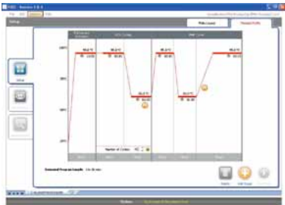
反应条件设置为图形界面，温度，时间一目了然，反 应进程均在界面上显示
