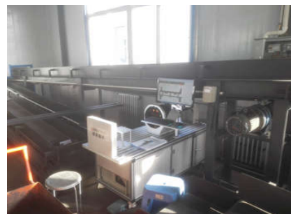
基于 MV-TOSEDP 技术的铸件尺寸检测
