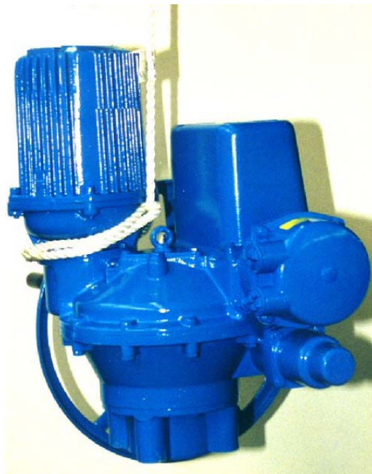
图1: 通过吊车对执行器搬运
