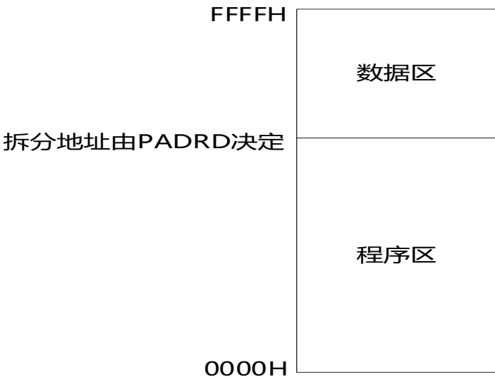
图 7-3-1 64K Flash 存储器结构
