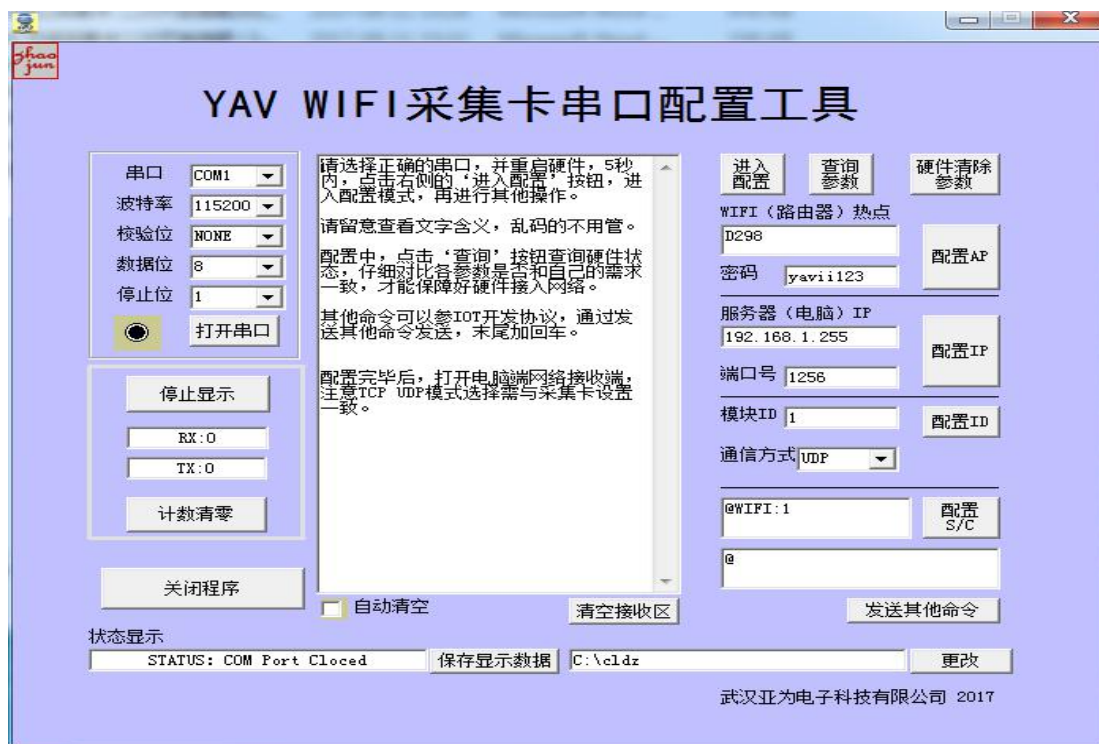
串口配置工具，新采集卡电脑 AP\IP 必须配置一次
