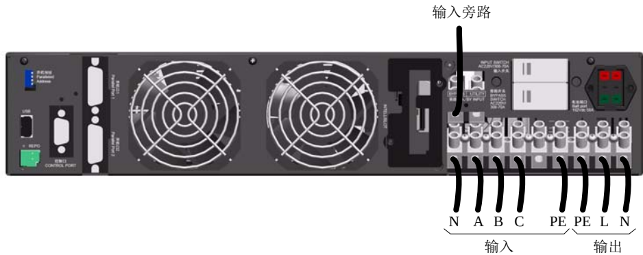
图2-19 三进单出、主旁不同源接线图
