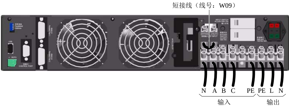
图2-18 三进单出、主旁同源接线图
