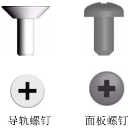
图2-9 导轨螺钉和面板螺钉
