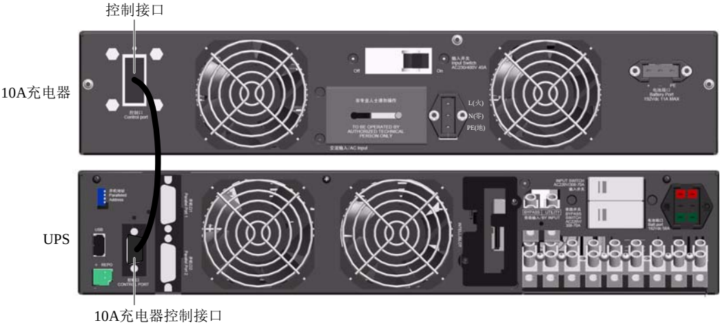
图2-26 10A 充电器电缆连接示意图
