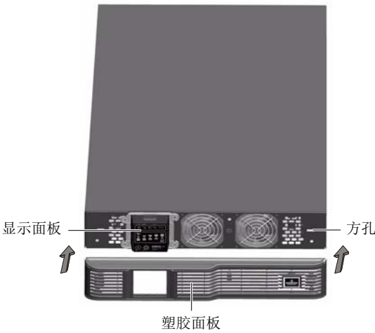
图2-3 安装塑胶面板
