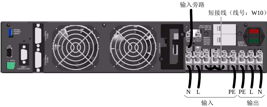
图2-17 单进单出、主旁不同源接线图
