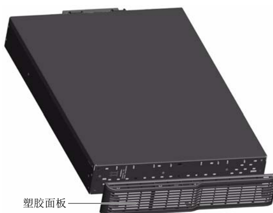
图8-2 电池塑胶面板拆卸图
