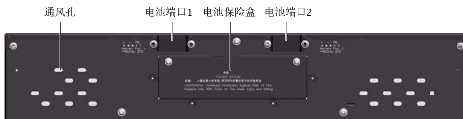
图8-3 电池模块后面板
