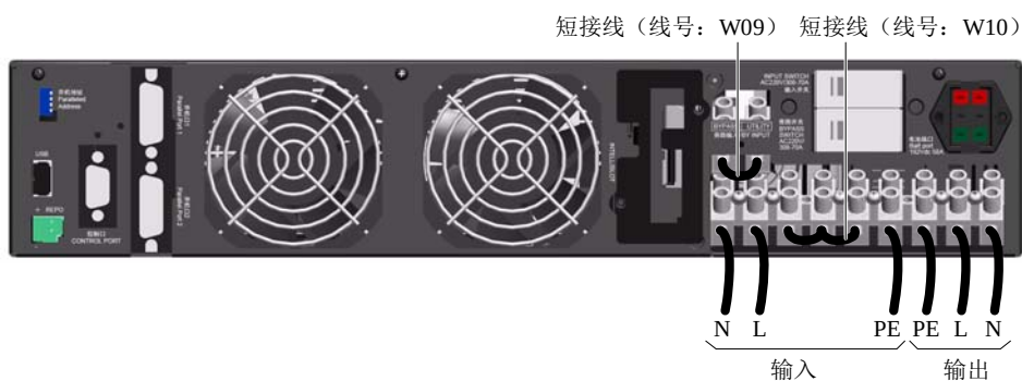
图2-16 单进单出、主旁同源接线图
