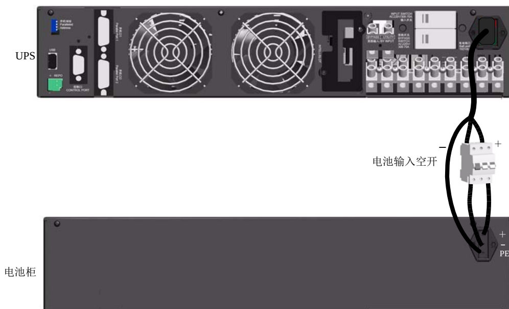
图2-24 长延时机型电池模块接线示意图
