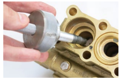
6. 使用阀座安装器按压单向阀确保他们在泵头内卡到位
