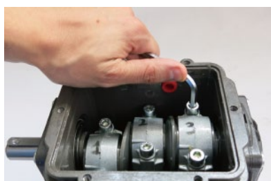
7. 移除连杆所有 6 个螺栓
