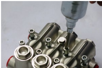
1. 使用气动枪移除8个泵头螺栓再用一字螺丝刀撬出(详见之前步骤)
