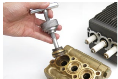
3. 旋转提取器并配合平衡块取出柱塞导杆
