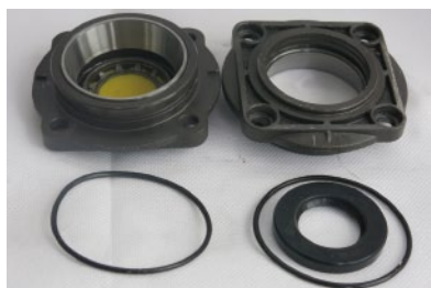
4. 移除曲轴油封以及 O 型圈
