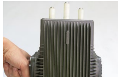
6. 旋转曲轴直到柱塞排列如图所示
