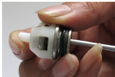
7. 检查单向阀的功能性和完整性, 例如 O型圈、提升阀、弹簧反应效率, 如果损坏更换相应部分或整个单向阀
