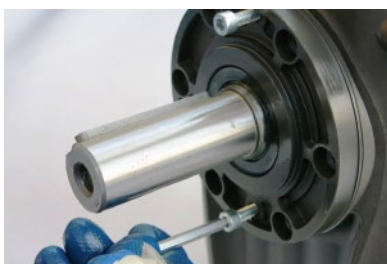
5. 将两个M6的螺栓放在端盖上的预留孔内，缓慢交替的旋转，直至端盖被推出。
