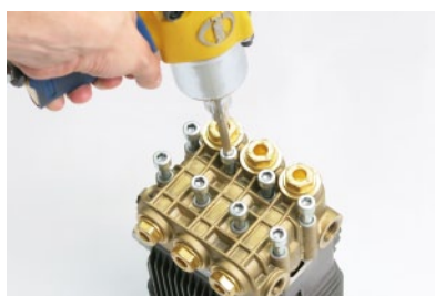
1. 使用气动枪移除 8 个泵头螺栓
