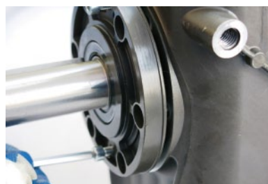
6. 当端盖和泵体分离时用手旋出螺栓
