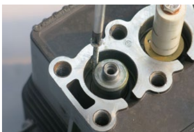
8. 警告：该步骤会完全损坏柱塞油封 将螺钉旋入油封时注意不要损伤柱塞连杆以及泵体，旋入的同时油封会跟着出来。
