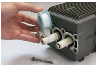
5. 如果柱塞无法取出就用生胶带缠绕数圈再用钳子夹住慢慢旋转移除
