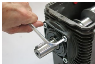
9. 拆除 PTO 侧端盖
