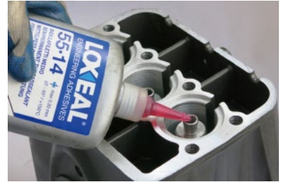
3. 添加Loxeal螺纹胶 (确保黄色垫片如图位置)
