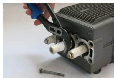
5. 如果柱塞无法取出就用生胶带缠绕数圈再用钳子夹住慢慢旋转移除
