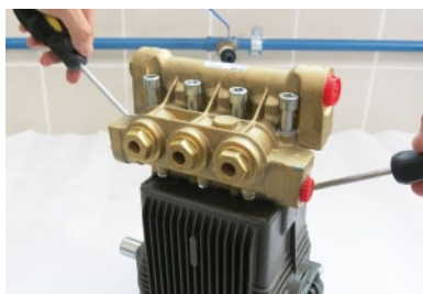
2. 使用两个一字螺丝刀从泵侧面缝隙中插入撑开泵头和泵体
