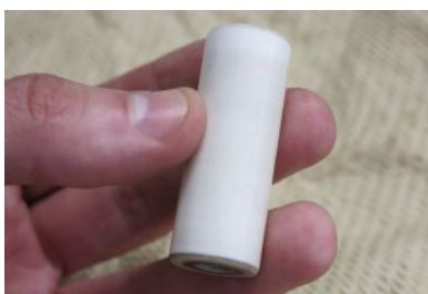
7. 检查柱塞有无划痕损坏以及裂纹等情况必要时更换
