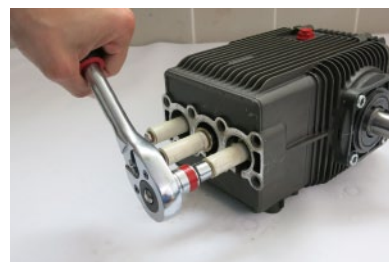
6. 手动移除陶瓷柱塞 ( 按照 6.1.4 的步骤 4-6 )
