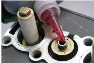
2. 添加 Loxeal 螺纹胶 ( 确保黄色垫片如图位置 )
