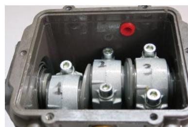
6. 在移除连杆后端前做好顺序标记方便后续安装
