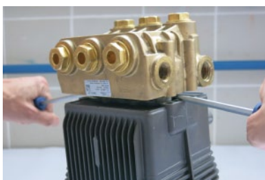
2. 使用两个一字螺丝刀从泵侧面缝隙中插入撑开泵头和泵体
