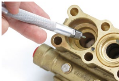
5. 使用尖嘴钳或单向阀提取器#1942580 + #1942590 + #2000210取出单向阀并检查所有单向阀的整体性
