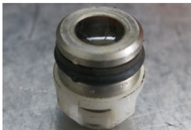
8. 如图将阀平放检查单向阀的密封性, 倒入一些水。水位不应下降。
