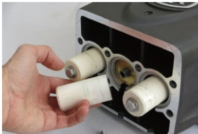
2. 拆除柱塞螺栓以及柱塞 ( 按照6.2.2的步骤4-6 )
