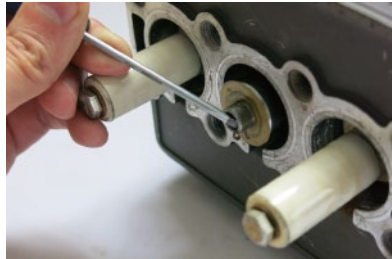
1. 清理柱塞导杆上残留的胶水
