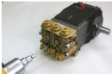
7. 泵头安装归位
