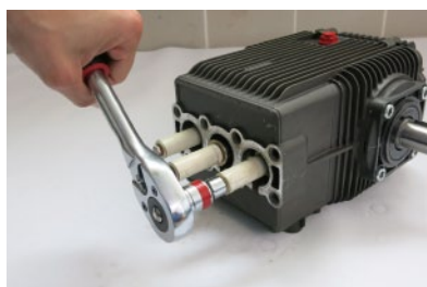
4. 手动 ( 千万不要使用气动以免损伤柱塞 ) 使用固定套筒移除柱塞螺栓
