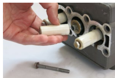
3. 拆除柱塞螺栓以及柱塞 ( 按照 6.1.4 的步骤 4-6 )
