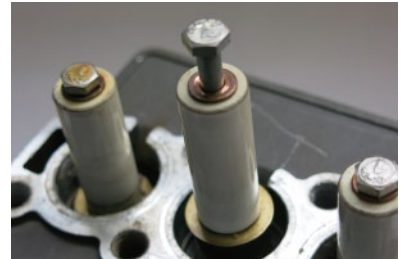
3. 把螺栓放到位旋紧并确认黄铜垫片 如图位置
