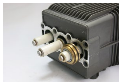
3. 如图所示有时会有密封套件卡在柱塞上请移除并放回泵头相应位置
