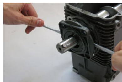
3. 移除两边的螺钉并用两把一字螺丝刀顶开
