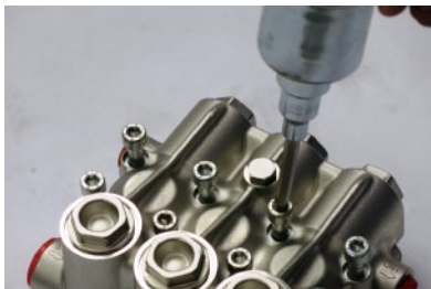
7. 泵头安装归位
