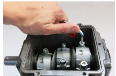
6. 移除连杆所有6个螺栓
