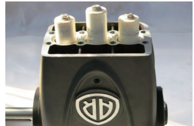
6. 旋转曲轴直到柱塞排列如图所示
