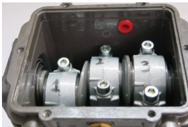
5. 在移除连杆后端前做好顺序标记方便后续安装
