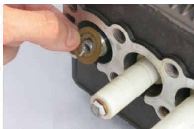
7. 移除柱塞垫片留着装回时使用
