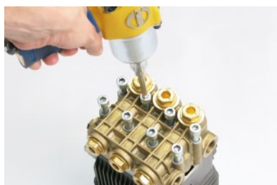
1. 使用气动枪移除 8 个泵头螺栓
